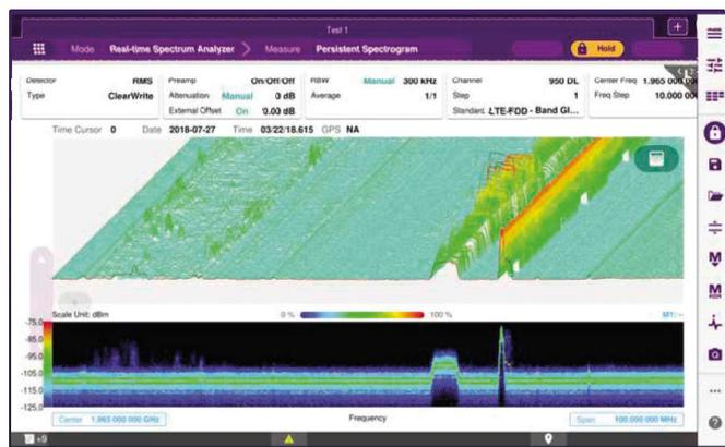
Figura 6. Visualizzazione a persistenza di interferenze a 2.4 GHz
